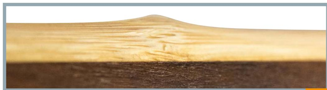
*Le collage au niveau des nœuds du bambou, là où il est le plus délicat, est très bien réalisé*
